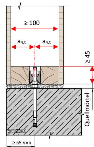
$a_{4,t} \geq 50\text{mm}$  (belasteter Rand Schub)
